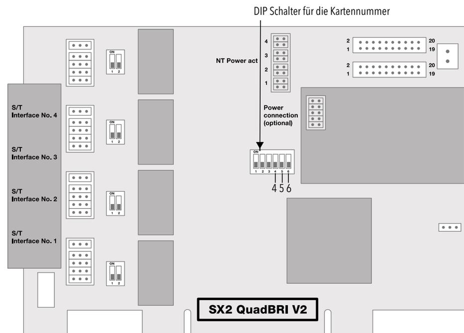
Abb. 13-1: Kartennummer-Konfiguration der SX2-express QuadBRI
