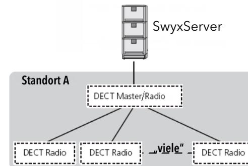
Abb. K-3: Installation an einem Standort
