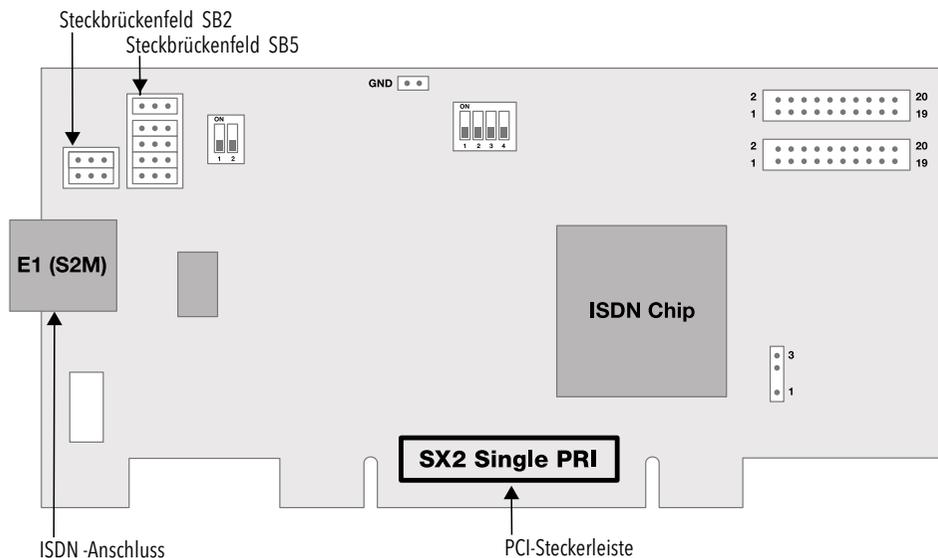
Dem E1-Anschluss sind zwei Steckbrückenfelder zugeordnet, die sich in unmittelbarer Nähe zur E1-Anschlussbuchse befinden. Im Folgenden wird das aus zwei Steckbrücken bestehende Feld mit SB2 und das aus 5 Steckbrücken bestehende Feld mit SB5 bezeichnet. Die Suffixe L und R geben an, ob alle Steckbrücken des jeweiligen Steckbrückenfeldes links (L) oder rechts (R) gesteckt sind. SB5R bedeutet beispielsweise, dass alle Steckbrücken des Feldes SB5 rechts gesteckt sind.
