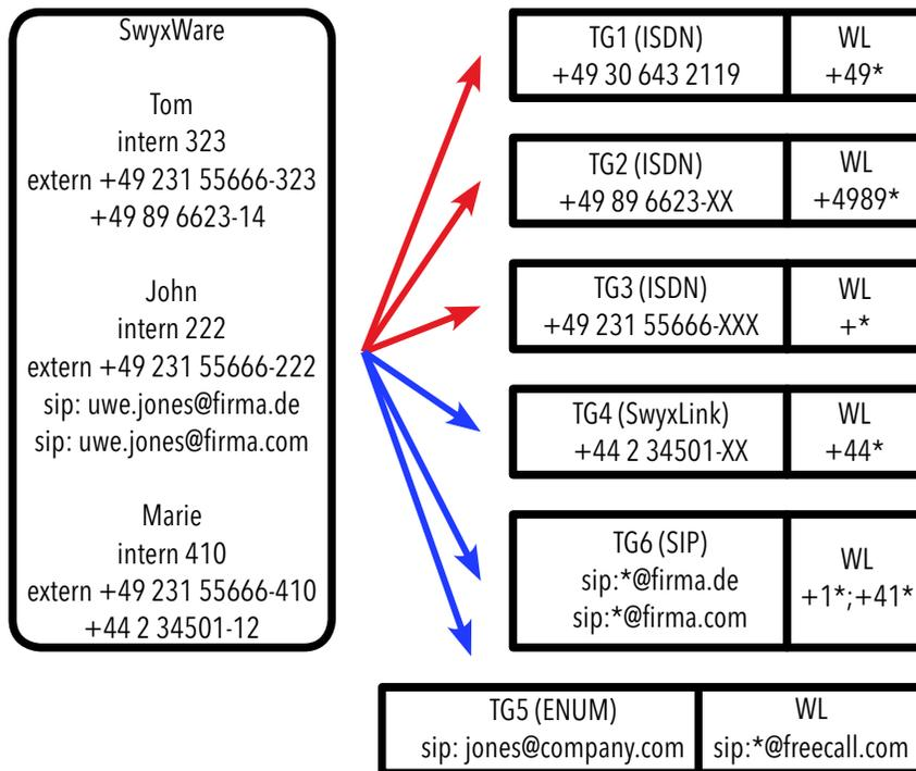
Abb. 8-1: Beispielkonfiguration für einen Rufnummernplan, Trunk-Gruppen (TG) und Weiterleitungen (WL)
