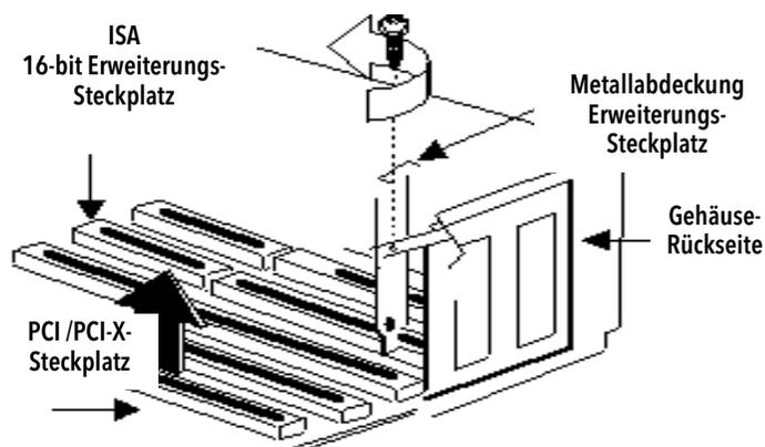
Abb. 13-5: Entfernen der Metallabdeckung
