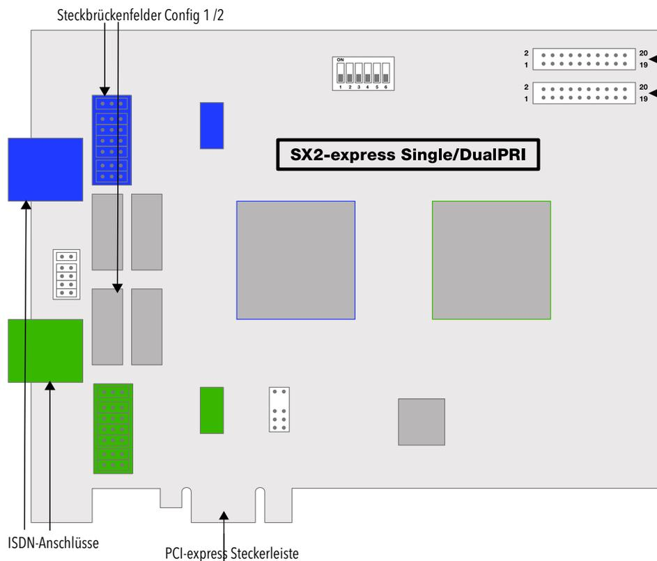
Jedem E1-Anschluss ist ein Steckbrückenfeld zugeordnet, welches sich in unmittelbarer Nähe zur E1-Anschlussbuchse befindet.
