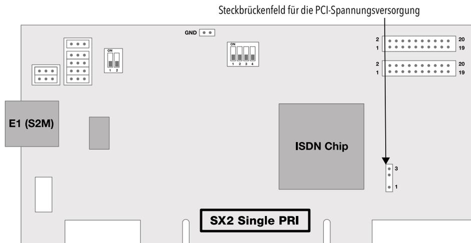
Stellen Sie sicher, dass sich die Steckbrücke in der richtigen Einstellung für die Computer-Hauptplatine befindet:
