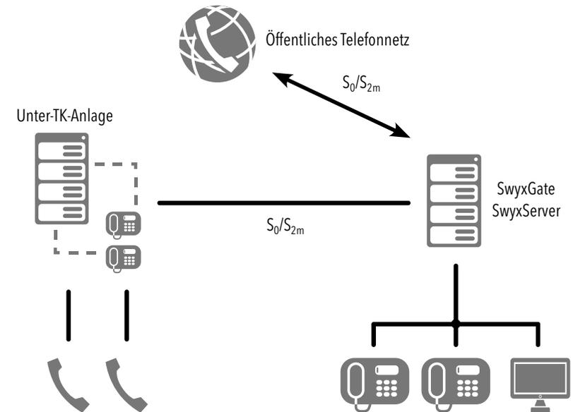
Abb. 3-5: SwyxGate angeschlossen zwischen PBX und PSTN
