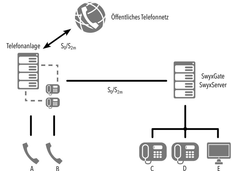
Abb. D-3: SwyxWare als Unter-TK-Anlage
