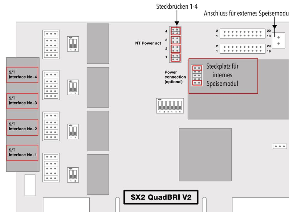
Für jede zu speisende NT-Schnittstelle setzen Sie die zwei Steckbrücken für jeden Port, den Sie mit Spannung versorgen möchten. Danach ist es möglich, ISDN-Endgeräte, die für die Speisung vom Amt vorgesehen sind, auch direkt an der SX2 QuadBRI V2 bzw. SX2-express QuadBRI zu betreiben.
