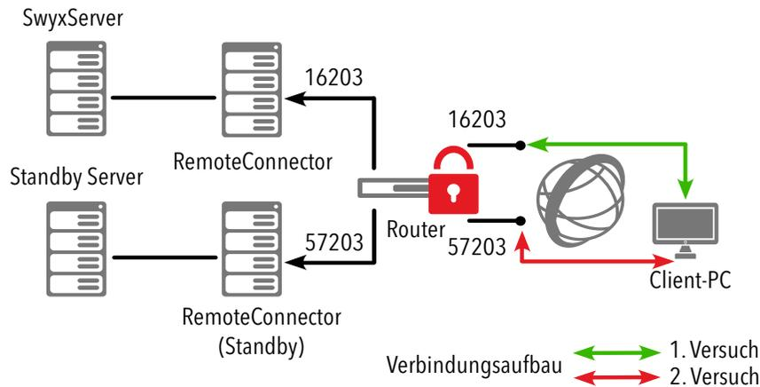
Abb. 24-1: Verbindungsaufbau zum RemoteConnector im Standby-Szenario
