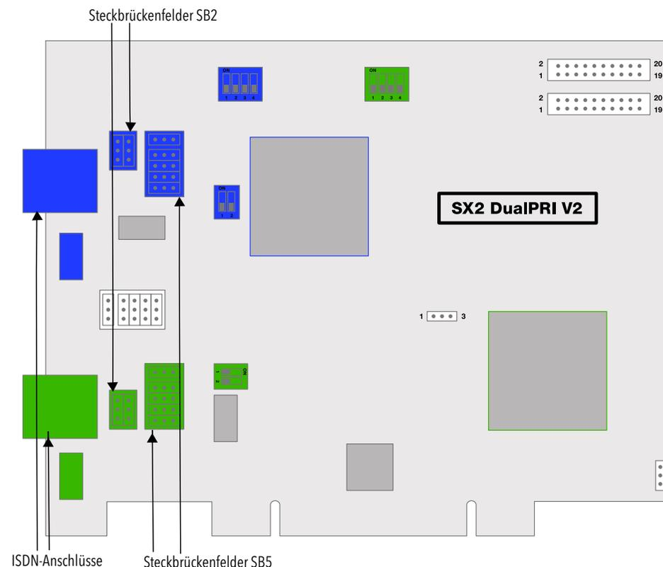
Jedem E1-Anschluss sind zwei Steckbrückenfelder zugeordnet, die sich in unmittelbarer Nähe zur E1-Anschlussbuchse befinden. Im Folgenden wird das aus zwei Steckbrücken bestehende Feld mit SB2 und das aus 5 Steckbrücken bestehende Feld mit SB5 bezeichnet. Die Suffixe L, R, O und U geben an, ob alle Steckbrücken des jeweiligen Steckbrückenfeldes links (L), rechts (R), oben (O) oder unten (U) gesteckt sind. SB5R bedeutet beispielsweise, dass alle Steckbrücken des Feldes SB5 rechts gesteckt sind.
