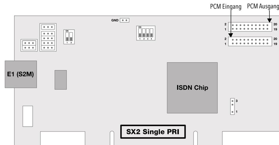
Die obere Buchse ist der Ausgang. Die untere Buchse ist der Eingang. Verbinden Sie die SX2-Karten mit dem PCM-Kabel, indem Sie die Aus-
