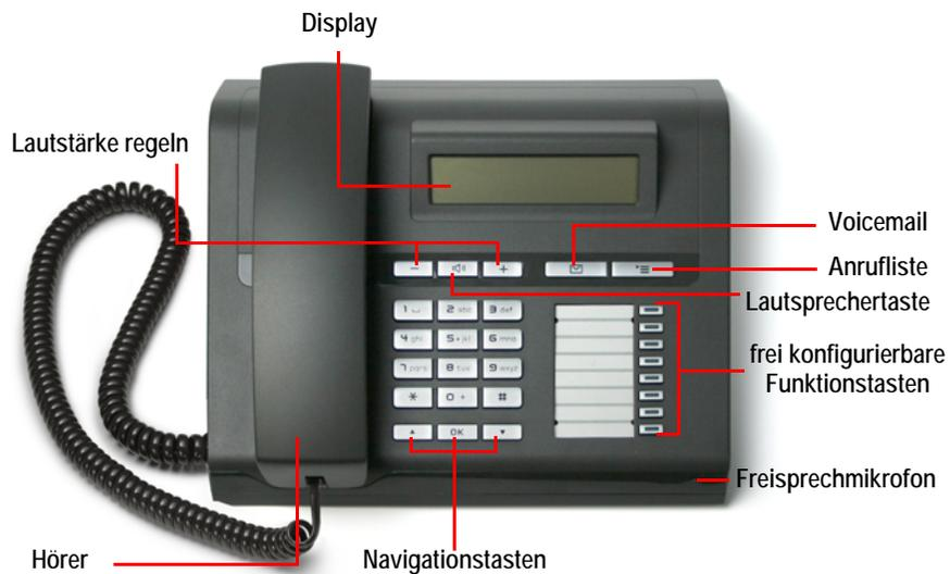
Abb. 5-1: Bedienelemente von SwyxPhone L615
