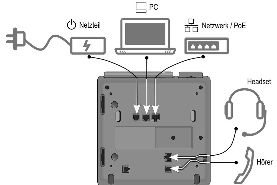
Abb. 4-3: Anschlüsse auf der Unterseite des SwyxPhone L66
