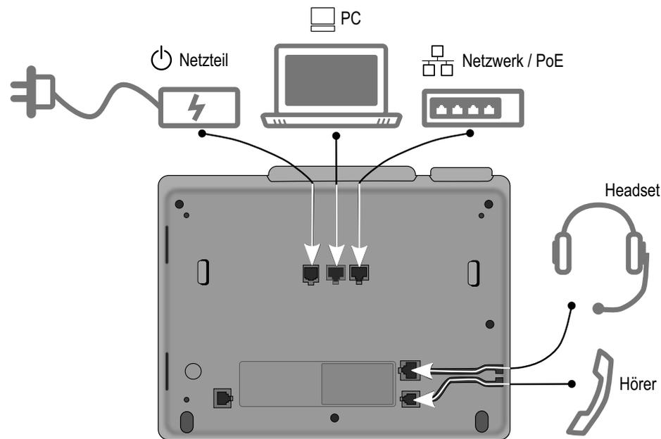
Abb. 4-2: Anschlüsse auf der Unterseite des SwyxPhone L64
