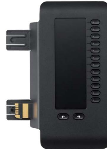
Das SwyxPhone Key Module 66 verfügt über 12 konfigurierbare Funktionstasten mit LEDs und zwei zusätzlichen Navigationstasten zum Umschalten zwischen zwei Ebenen. Die Tastenbeschriftung erfolgt über das monochrome TFT-Display. Sie können bis zu vier SwyxPhone Key Module 66 an SwyxPhone L66 anschließen.
