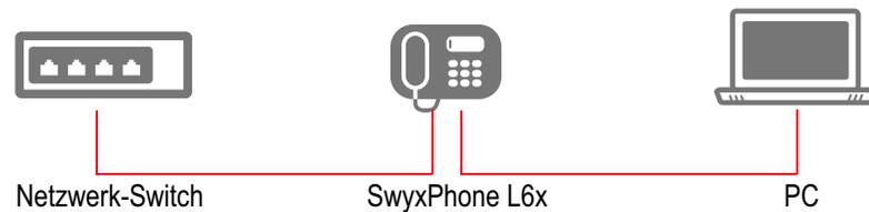
Durch die Anschlussart sparen Sie jeweils einen Netzwerk-Anschluss des verwendeten Switches und benötigen bei entsprechender Anordnung weniger Netzwerk-Kabel bzw. nutzen kürzere Leitungswege.
