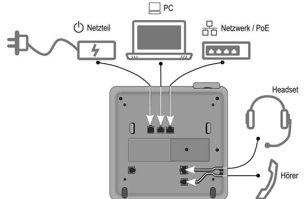
Abb. 4-1: Anschlüsse auf der Unterseite des SwyxPhone L62
