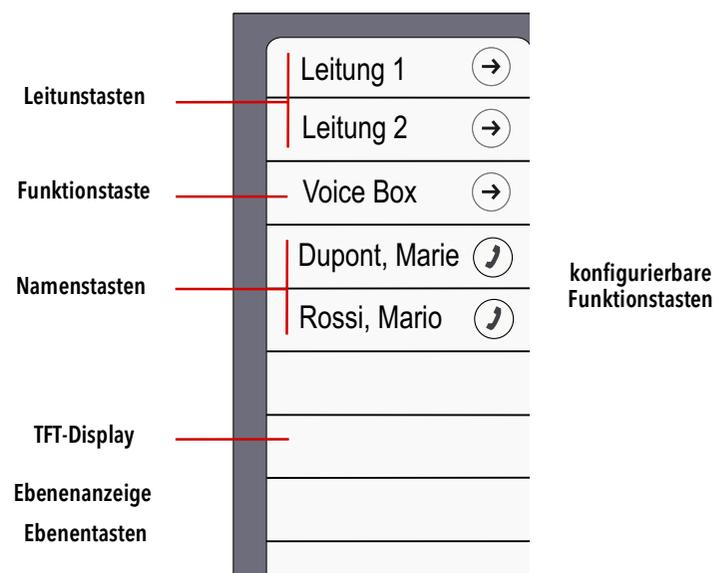
Abb. 13-1: SwyxPhone Key Module 66: Beispielkonfiguration
