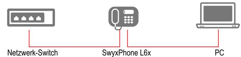
Durch die Anschlussart sparen Sie jeweils einen Netzwerk-Anschluss des verwendeten Switches und benötigen bei entsprechender Anordnung weniger Netzwerk-Kabel bzw. nutzen kürzere Leitungswege.
