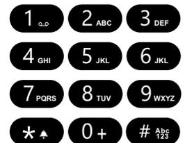
Im inaktiven Zustand, wenn keine Gespräche geführt werden und keine Menüs geöffnet sind, können Sie die Rufnummer direkt eingeben. Haben Sie ein Menü geöffnet, können Sie einen Menüpunkt über die Zifferntaste direkt aufrufen.
