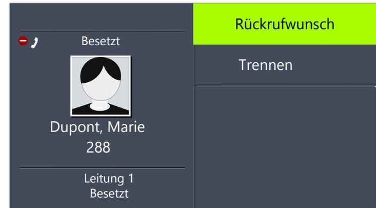
Ist die Verbindung aufgebaut, so erscheint in der ersten Displayzeile die Gesprächsdauer. In den nächsten Displayzeilen werden die Leitungsnummer und die Nummer bzw. der Name des Zielteilnehmers angezeigt:
